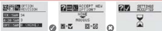
**Figura 1. Actualización del XNX para placas opcionales añadidas o retiradas**
