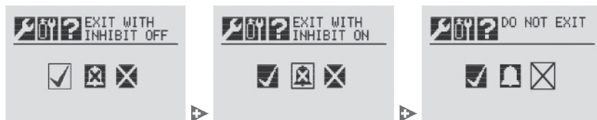
рис. 11. Завершение сеанса калибровки по ноль-газу и проверочной смеси
