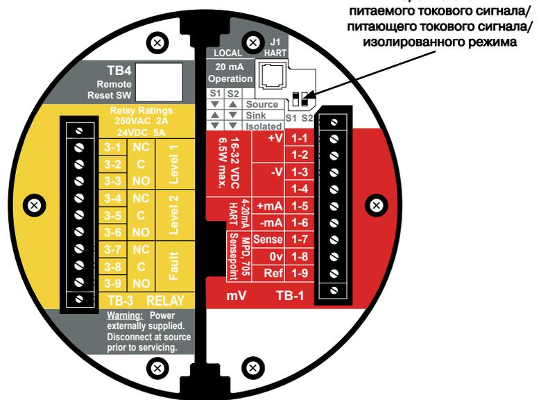
Переключатели питаемого токового сигнала/ питающего токового сигнала/ изолированного режима
