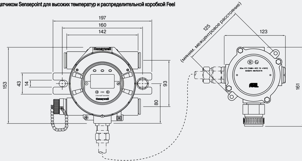
XNX с дистанционным датчиком Sensepoint модели 705 для высоких температур и распределительной коробкой
