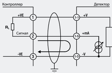
Конфигурация XNX с питаемым токовым сигналом
