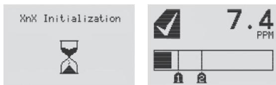
Figura 28. Schermate di inizializzazione e di stato generale dell'XNX
