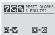
Figura 36. Schermata di azzeramento dell'allarme
