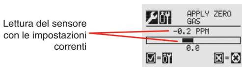
Figura 43. Schermata di taratura dello zero
