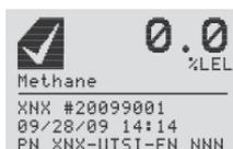
Figura 40. Schermata di stato generale con informazioni sull'unità
