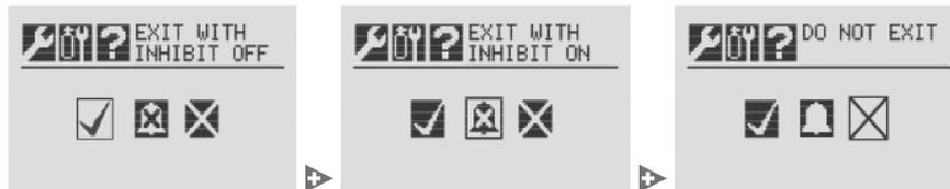
Abbildung 11. Beenden der Nullgas- und Kalibriergaskalibrierung
