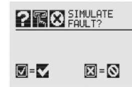
Abbildung 19. Bestätigung der Fehlersimulation
