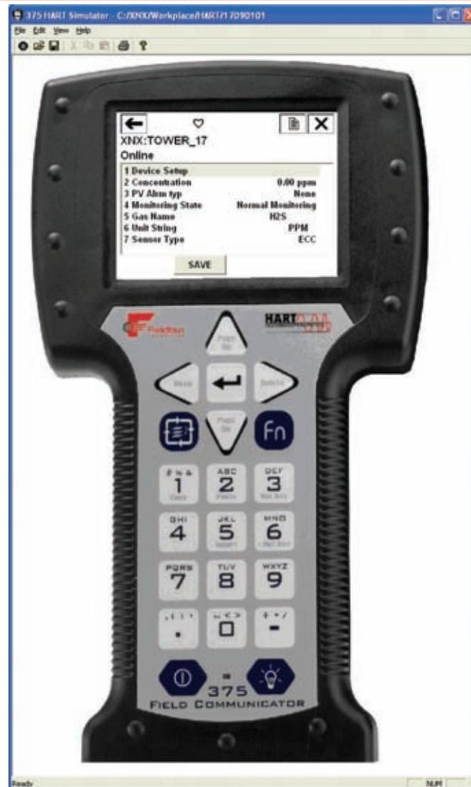
Figura A-7. Apresentação dos dados do XNX usando Emerson 375 (simulador mostrado)
