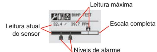
Figura 3-12. Tela do teste de reação
