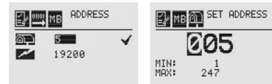
Figura 2-103. Tela de definição do endereço de Fieldbus e tela do valor de endereço
