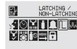
**Figura 2-58. Tela de alarme bloqueado/não bloqueado**
