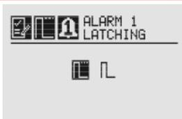
Figura 2-60. Configuração de alarme bloqueado/desbloqueado
