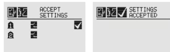
Figura 2-96. Aceitar novas configurações do relé de alarme e Novas configurações aceitas
