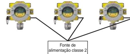
Figura 2-5. Muitos transmissores alimentados por uma única fonte de alimentação
