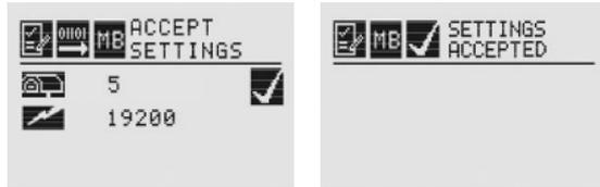
Figura 2-105. Aceitar configurações e Configurações do endereço de Fieldbus aceitas
