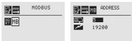
Figura 2-147. Tela de exibição da configuração do Modbus
