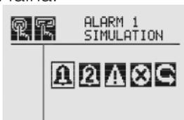
Figura 2-120. Menu de simulação de alarme/falha
