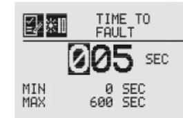
**Figura 2-78. Configuração do tempo de falha de bloqueio do feixe**
