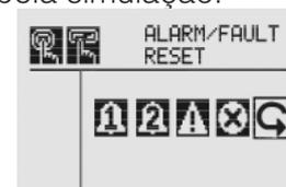
Figura 2-124. Tela de redefinição de alarme/falha
