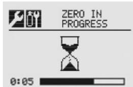
Figura 3-4. Calibração zero em andamento
