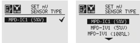
**Figura 2-42. Sensor mV configurado atualmente e lista de sensores mV disponíveis**
