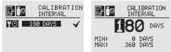
**Figura 2-70. Telas de edição do intervalo e de definição do valor do intervalo**
