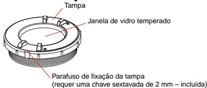
A tampa do transmissor é fornecida em material idêntico ao especificado para o invólucro. Uma janela de vidro temperado exige o uso de chave de fenda/vara magnética fornecida para ativar os quatro interruptores da interface de usuário, localizados na frente do
