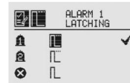
**Figura 2-59. Bloqueio de alarme**
