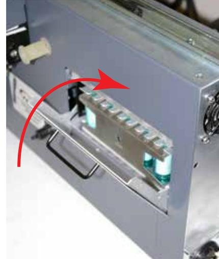
Abbildung 5-3. Zugangstür zu Analyzer-Filtern
