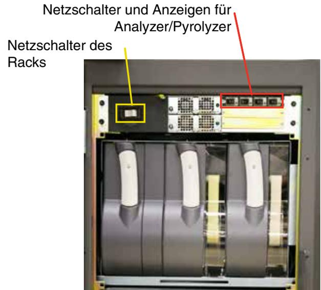
Abbildung 2-3. Netzschalter des Racks
