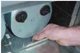
5. Schieben Sie die Pumpe aus dem Gehäuse heraus.
