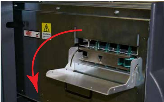
Abbildung 5-5. Filtertür des Pyrolyzers
