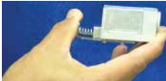
Ziehen Sie dann die Armaturen zum Lösen von der Pumpe nach oben.
