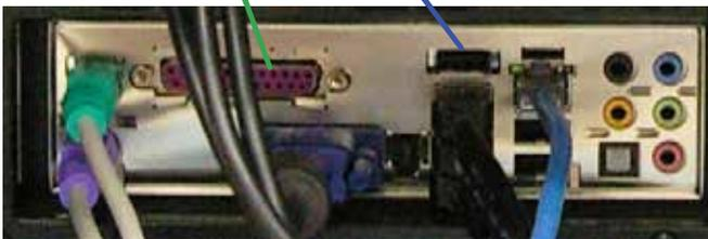
Abbildung 2-5. Druckeranschluss
