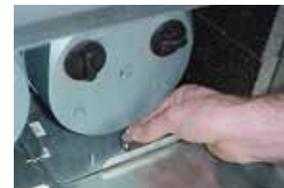
4. Drücken Sie die Schiebeplatte zum Wiedereinbau auf die Armatur.
