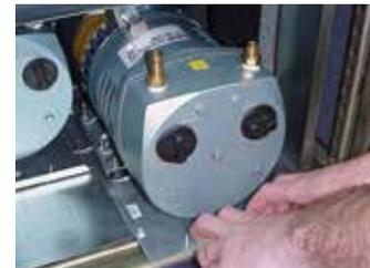
2. Drücken Sie die Pumpe vollständig in das Gehäuse hinein, bis der Freigabeknopf am Boden des Gehäuses einrastet.
