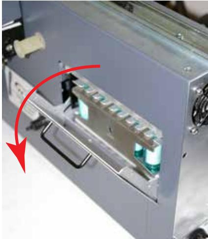
Abbildung 5-1. Zugangstür zu Analyzer-Filtern
