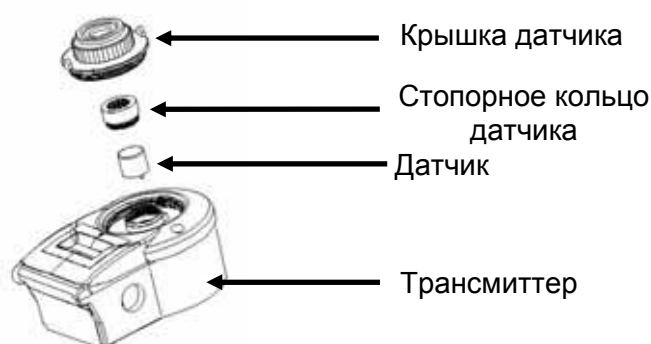
Рис. 7. Замена вставного датчика
