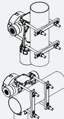
Монтаж на вертикальной или горизонтальной трубе
