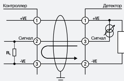
Конфигурация XCD с питающим токовым сигналом
