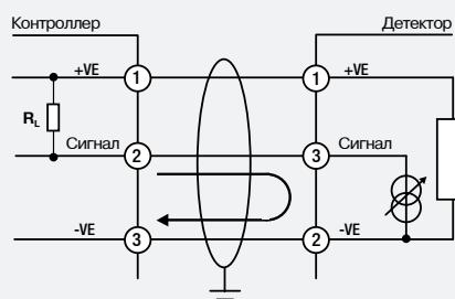
Конфигурация XCD с питаемым токовым сигналом
