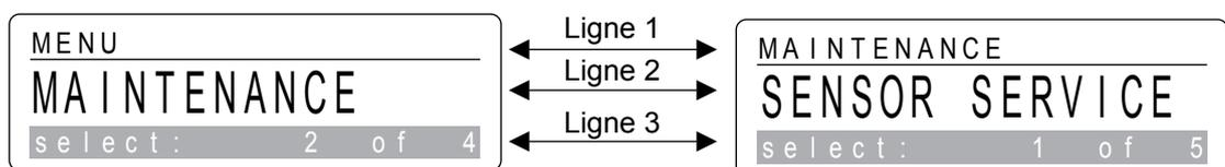
La ligne 1 donne l'emplacement réel dans le menu. L'exemple de gauche illustre une position réelle dans le menu principal tandis que l'exemple de droite illustre une position dans le sous-menu Maintenance. La ligne 2 indique l'un des choix possibles. La ligne 3 indique le nombre de choix possibles actuellement affichés, ainsi que le nombre total de choix possibles dans le menu en question.
