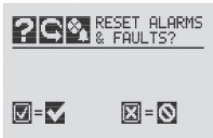
Figura 36. Pantalla de reinicio de alarma
