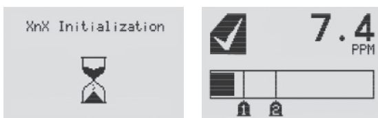
Figura 27. Inicialización del XNX y pantallas de estado general
