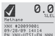
Figura 40. Pantalla de estado general con información de unidades
