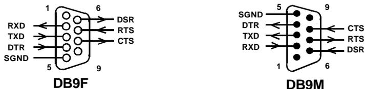
Figura 11 Patillas normales del conector RS232.
