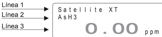
La estructura de la pantalla gráfica varía según el modo de funcionamiento. A continuación se ilustran y explican tres versiones básicas. Se puede encontrar una descripción detallada en las secciones correspondientes.
