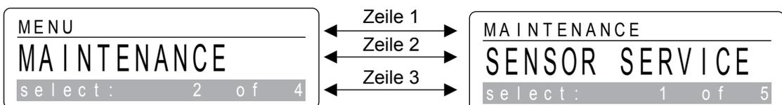
Zeile 1 stellt die gegenwärtige Position im Menü dar. Im linken Beispiel handelt es sich bei der aktuellen Position um das Hauptmenü, im rechten Beispiel um das Untermenü „Wartung“. Zeile 2 zeigt eine der Auswahlmöglichkeiten. Zeile 3 enthält die Nummer der derzeit angezeigten Auswahlmöglichkeit sowie die Gesamtzahl der in diesem Menü verfügbaren Auswahlmöglichkeiten.
