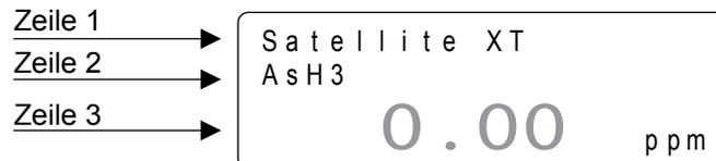
Zeile 1 bietet die Möglichkeit zur Eingabe einer individuellen Nutzerbeschreibung, z. B. dem Überwachungsort (max. 13 Stellen; der Gerätenamen ist werksseitig vorgegeben). Zeile 2 enthält die Bezeichnung des überwachten Gases. Zeile 3 zeigt die aktuelle Gaskonzentration und die entsprechende Einheit an. Die Daten zu Gasbezeichnung und Konzentrationseinheit sind im Speicher des installierten Sensors gespeichert.
