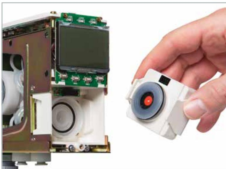
Готовый к использованию картридж датчика для обнаружения газа Midas позволяет произвести быструю и простую замену датчика
