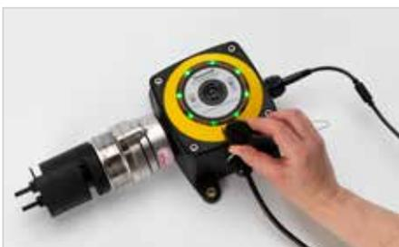
La caja se configura mediante un conmutador magnético. El tapón, que incorpora un imán, queda enroscado en el centro de la tapa de la caja cuando no se utiliza. Es posible configurar los siguientes parámetros: -
