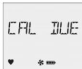
(например) **CAL DUE 180 d** (калибровка должна быть выполнена через 180 дней). Так как некоторые датчики требуют более частой калибровки, дисплей будет показывать самую раннюю калибровку, которая должна быть выполнена.
