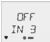
2. Затем детектор снова активируется и выполнит обратный отсчет **CAL** (калибровка). Для входа в режим калибровки продолжайте удерживать кнопку
